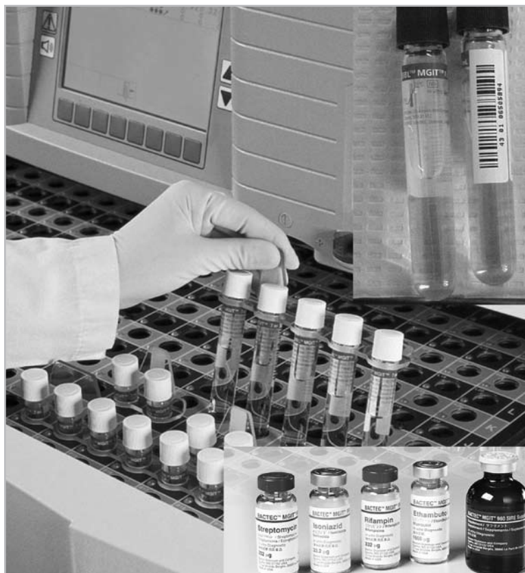
Figura 1. BACTEC MGIT Sistema BACTEC MGIT (tubo indicador de crecimiento micobacterial) – Máquina MGIT. Arriba, a la derecha: Los tubos MGIT. Abajo a la derecha: Soluciones de antibióticos para realizar pruebas de susceptibilidad en el MGIT.
